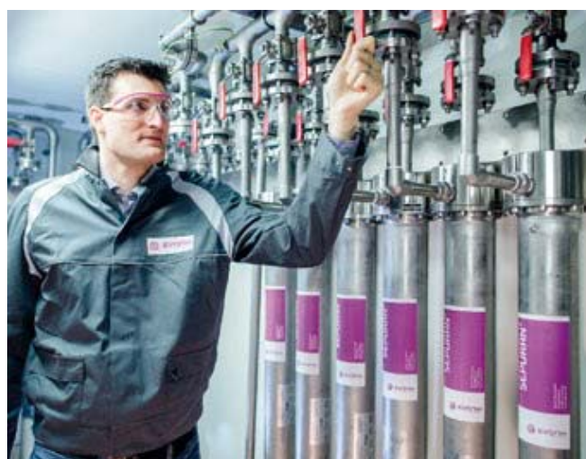
EVONIK社製 バイオガス膜 SEPURAN® Green
